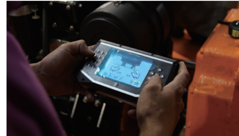
採用雷射對心儀精確對接軸心
